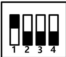
RS232 모드A: 후면 D-SUB 9PIN MALE에 연결하여 RS232통신으로 8개 채널 광량 설정 (프로토콜 참조)
